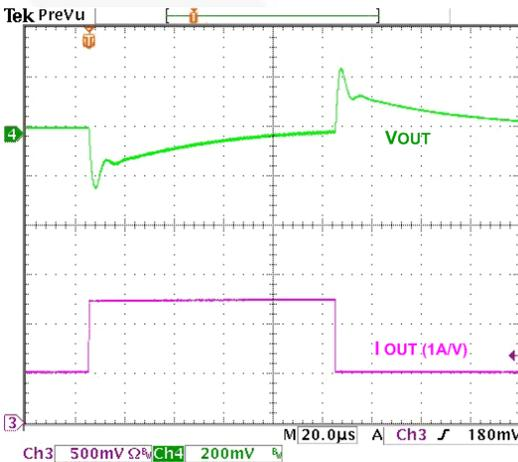
Figure 21. Load Transient, 500-1250 mA, 100 ns Edge
