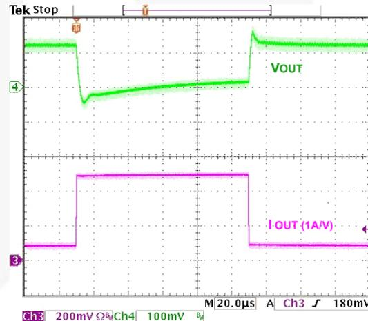
Figure 20. Load Transient, 100-500 mA, 100 ns Edge
